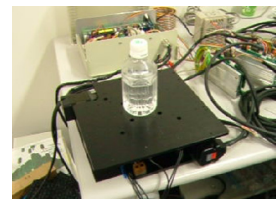
図9 推定地震動を準リアルタイムに再現する2軸卓上振動台
